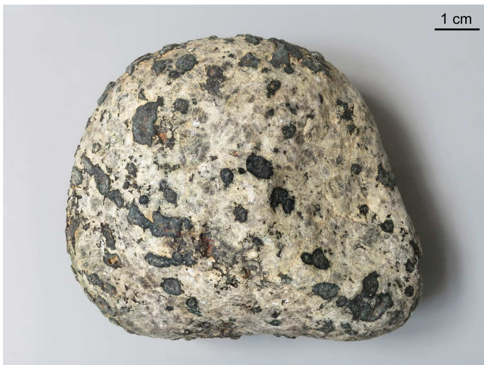
Abb. 29: Anorthosit (Nr. 114), Aufnahme unter Wasser. Das Gestein besteht zum großen Teil aus Plagioklas. Auch hier ist ein coronitisches Gefüge, eine unvollständige Mineralreaktion an der Grenzfläche zwischen Plagioklas und dunklen Mineralen erkennbar.
