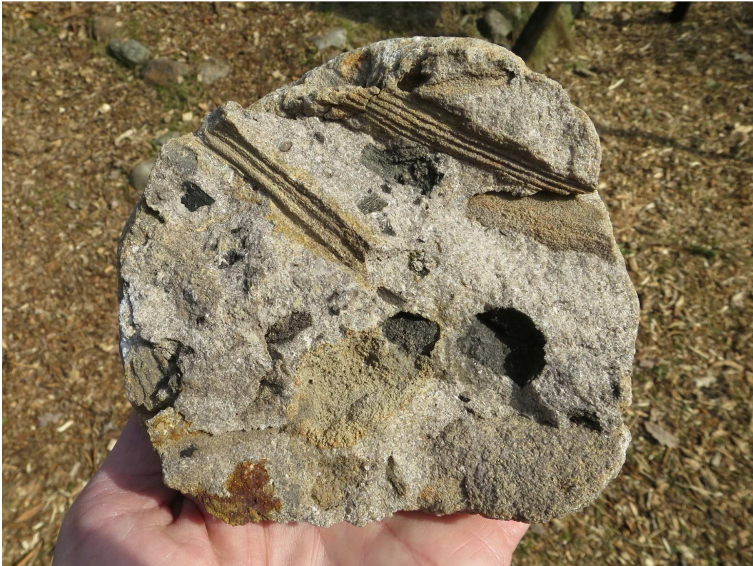
Abb. 173: Bruchfläche eines „ Braunkohlenquarzits “, ein heller und verkieselter Sandstein mit kohligen Holzresten. Teilweise wurde die Holzsubstanz vollständig verdrängt, nur noch die äußere Gestalt ist erhalten.
