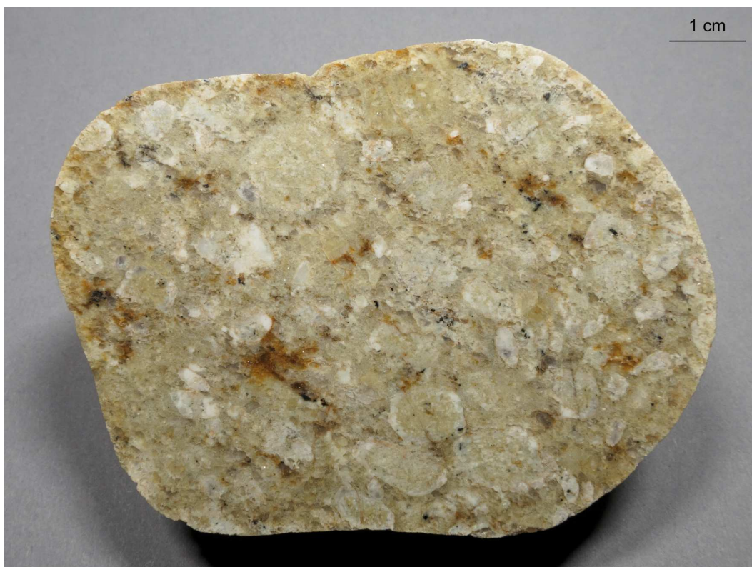
Abb. 91: Weißer Filipstad-Granit (Nr. 5), polierte Schnittfläche. Einige der cremefarbenen und runden Alkalifeldspat-Einsprenglinge sind von einem helleren Saum aus Plagioklas umgeben. Die Matrix besteht aus xenomorphem und hell- bis blaugrauem Quarz sowie Alkalifeldspat. Dunkle Minerale sind nur in sehr geringer Menge enthalten.
