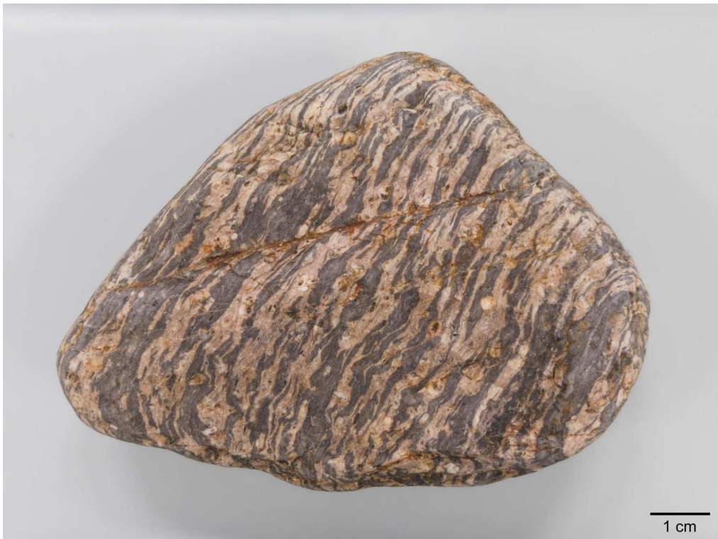
Abb. 60: Fluidaler Metavulkanit ( Småland-Hälleflinta ), Nr. 2571. Die wenigen hellen Feldspat-Einsprenglinge erscheinen undeformiert, werden aber von den dunklen Flasern nicht umflossen (kein eutaxitisches Gefüge).
