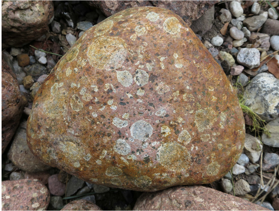
Abb. 92: Rotbrauner Rapakiwigranit mit Wiborgit-Gefüge ( Åland-Wiborgit ), Breite 12 cm. Die Alkalifeldspat-Ovoide besitzen einen weißen Saum aus Plagioklas und treten durch Verwitterung stärker hervor.
