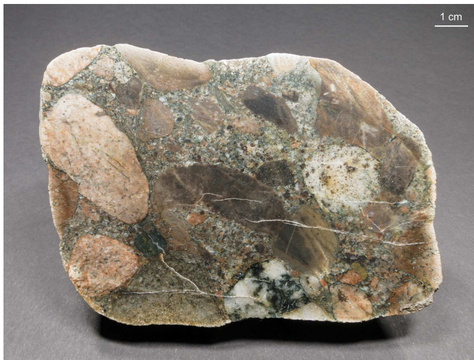
Abb. 129: Gleicher Stein, polierte Schnittfläche; unten im Bild ein quarzreicher Lithoklast mit Chlorit.
