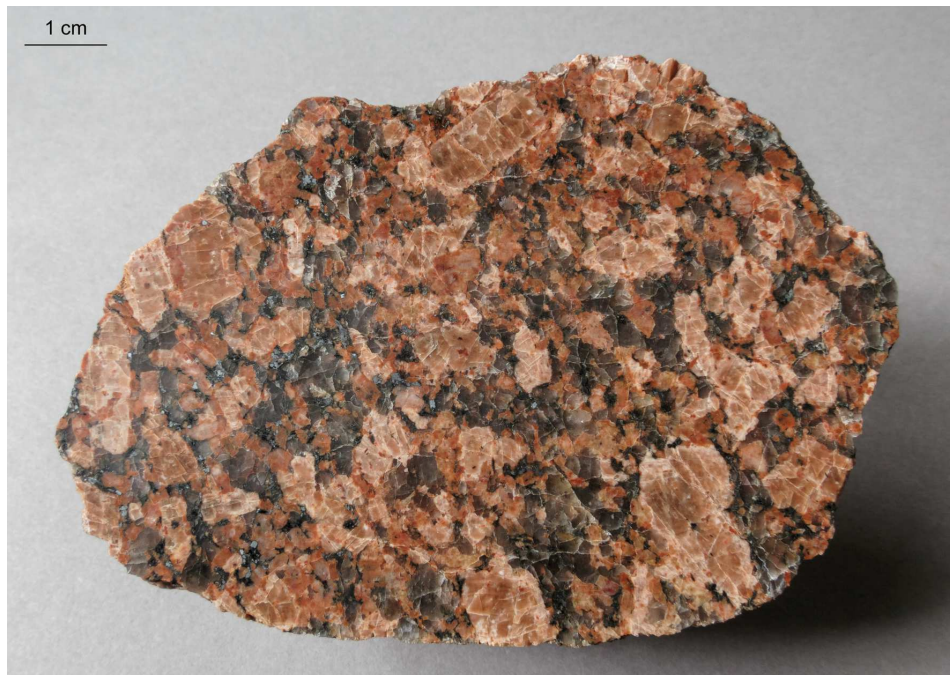
Abb. 94: Lemland-Granit (Nr. 123), polierte Schnittfläche. Der porphyrische Granit besteht aus größeren Einsprenglingen von hellbraunem Alkalifeldspat sowie rotem Plagioklas und dunkelgrauem und xenomorphem Quarz.
