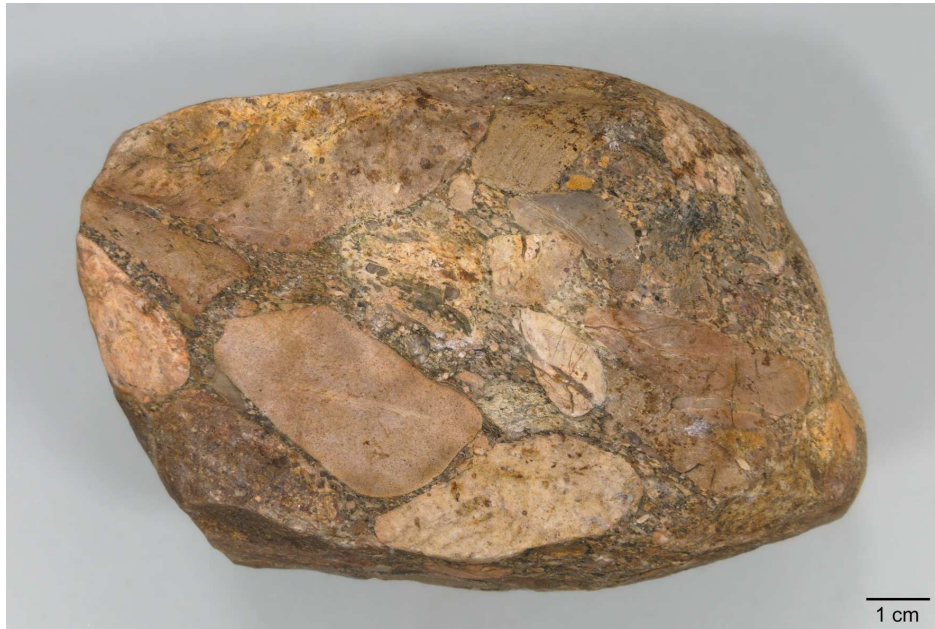
Abb. 128: Polymiktes Metakonglomerat (Nr. 1745), Aufnahme unter Wasser. Die sandige Matrix enthält kantengerundete und hell- bis dunkelbraune Lithoklasten (aphanitische Vulkanite, Quarzporphyre, feinkörnige Granite, feinkörnige Sedimentite und Sandstein). Leicht eingeregelter und ausgelängter Körner in der Matrix sind ein Hinweis auf eine leichte tektonische Überprägung des Gesteins.
