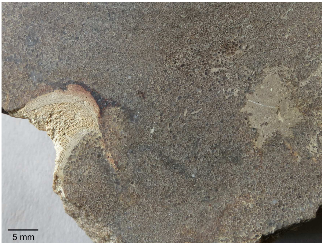
Abb. 174: „ Tertiärquarzit “, Anschnitt eines verkieselten Sandsteins mit einem Fragment eines hellen Kieselholzes.
