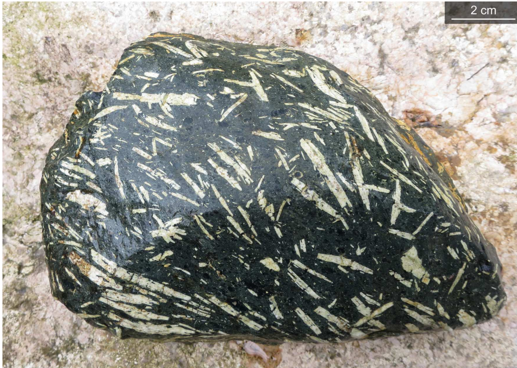
Abb. 15: Grünschwarzes basaltisches Gestein mit leistenförmigen Plagioklas-Einsprenglingen ( Diabas ), Nr. 33. Die Grünfärbung ist auf hydrothermale Umwandlung der primären Minerale Pyroxen und Plagioklas in Amphibol, Chlorit, Epidot o.ä. zurückzuführen.
