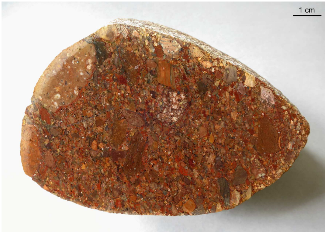
Abb. 124: Lapillituff (Digerberg-Tuffit) mit größeren Vulkanit-Lithoklasten und einer Matrix aus kleinen Vulkanit-Lithoklasten mit geringem sandigem Anteil. Herkunft aus der Digerberg-Formation ist wahrscheinlich. Polierte Schnittfläche.
