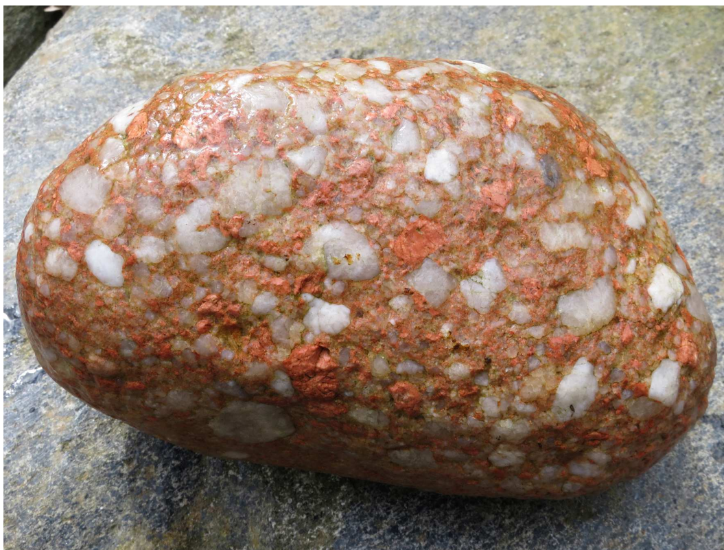
Abb. 135: Aus der KFH stammen mehrere bunte konglomeratische Arkose-Sandsteine unbekannter Herkunft. Milchquarz-Gerölle und größere hellrote Feldspäte liegen in einer Matrix, die ebenfalls aus Quarz und Feldspat besteht. Breite 14 cm.
