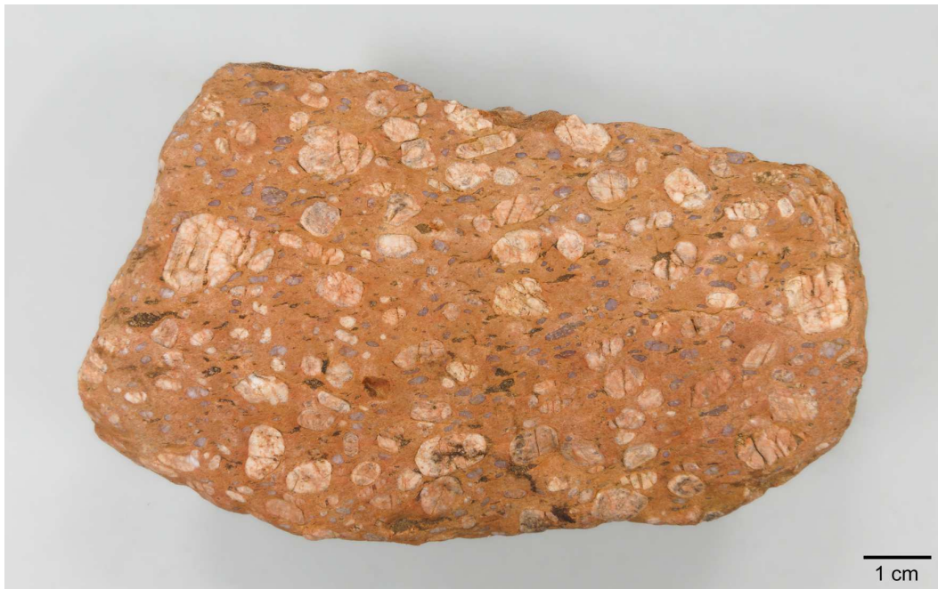
Abb. 56: Rotbrauner Påskallavik-Porphyr (Nr. 2105) mit rundlichen, teilweise „zerknackten“ Feldspat-Einsprenglingen und länglichen hellblauen Quarz-Einsprenglingen. Aufnahme unter Wasser.
