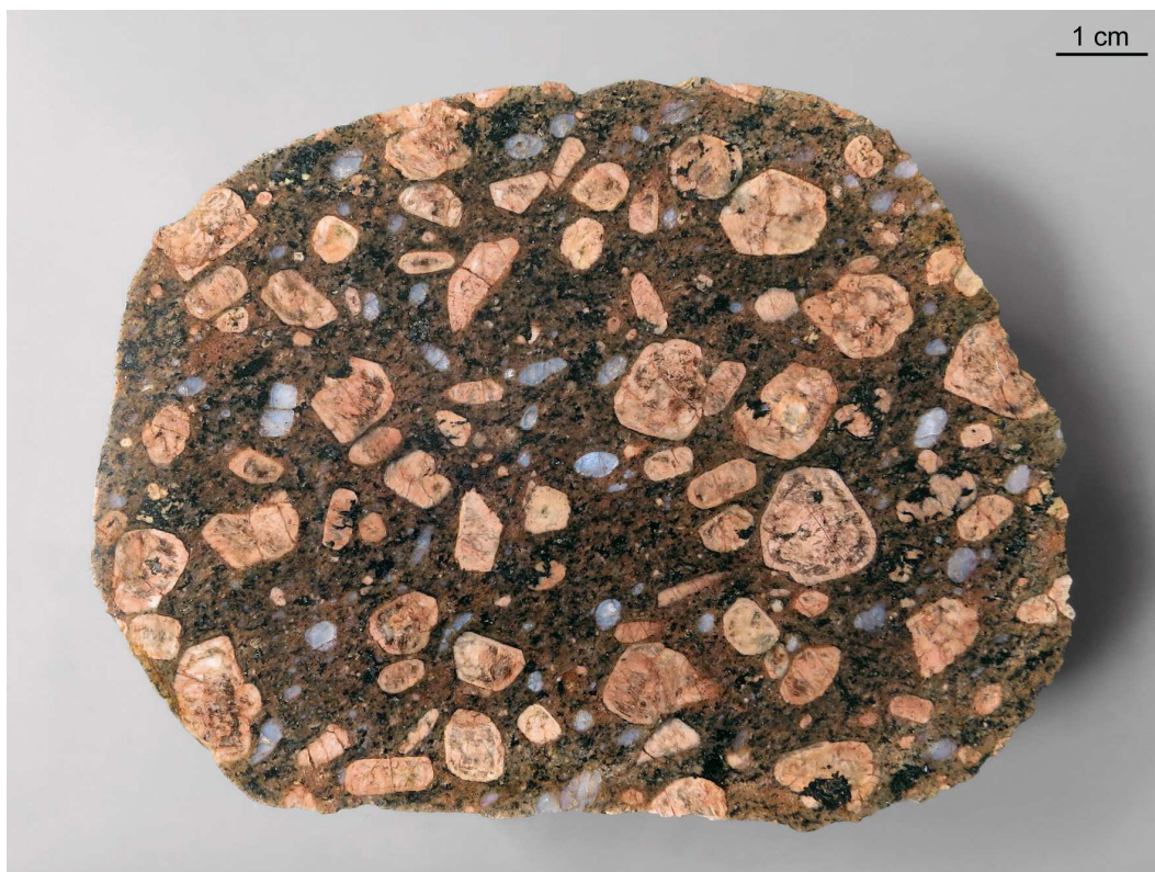
Abb. 55: Påskallavik-Porphyr (Nr. 117), Aufnahme einer Schnittfläche unter Wasser. Die braune und feinkörnige Grundmasse ist von dunklen Mineralen durchsetzt. Hellrote und abgerundete Feldspäte, teilweise mit dunklen Kernen sowie leuchtend blaue Quarze bilden ein kontrastreiches Gefüge.
