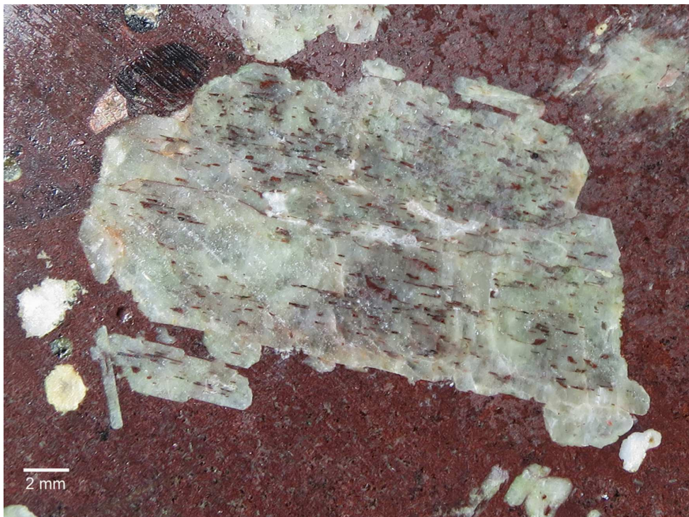
Abb. 17: Gleicher Stein, Nahaufnahme eines Plagioklases mit magmatischen Korrosionserscheinungen (randliche Auflösung). Entlang der Spaltflächen sind Einschlüsse der feinkörnigen rotbraunen Grundmasse erkennbar.
